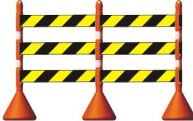
Los señalizadores deben contar con por lo menos dos cintas retroreflectivas blancas de 3 pulgadas de ancho, de especificación mínima de grado ingeniería y deben contar con un lastre que proporcione estabilidad para que permanezcan en posición durante la obra. El lastre no puede ser fabricado ni contener materiales no deformables como concreto o piedras.
